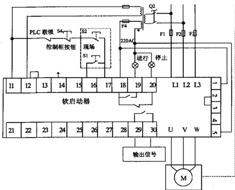
图2 软启动器对屏蔽泵的控制
