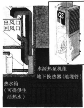
图 3 水源热泵机组示意图
