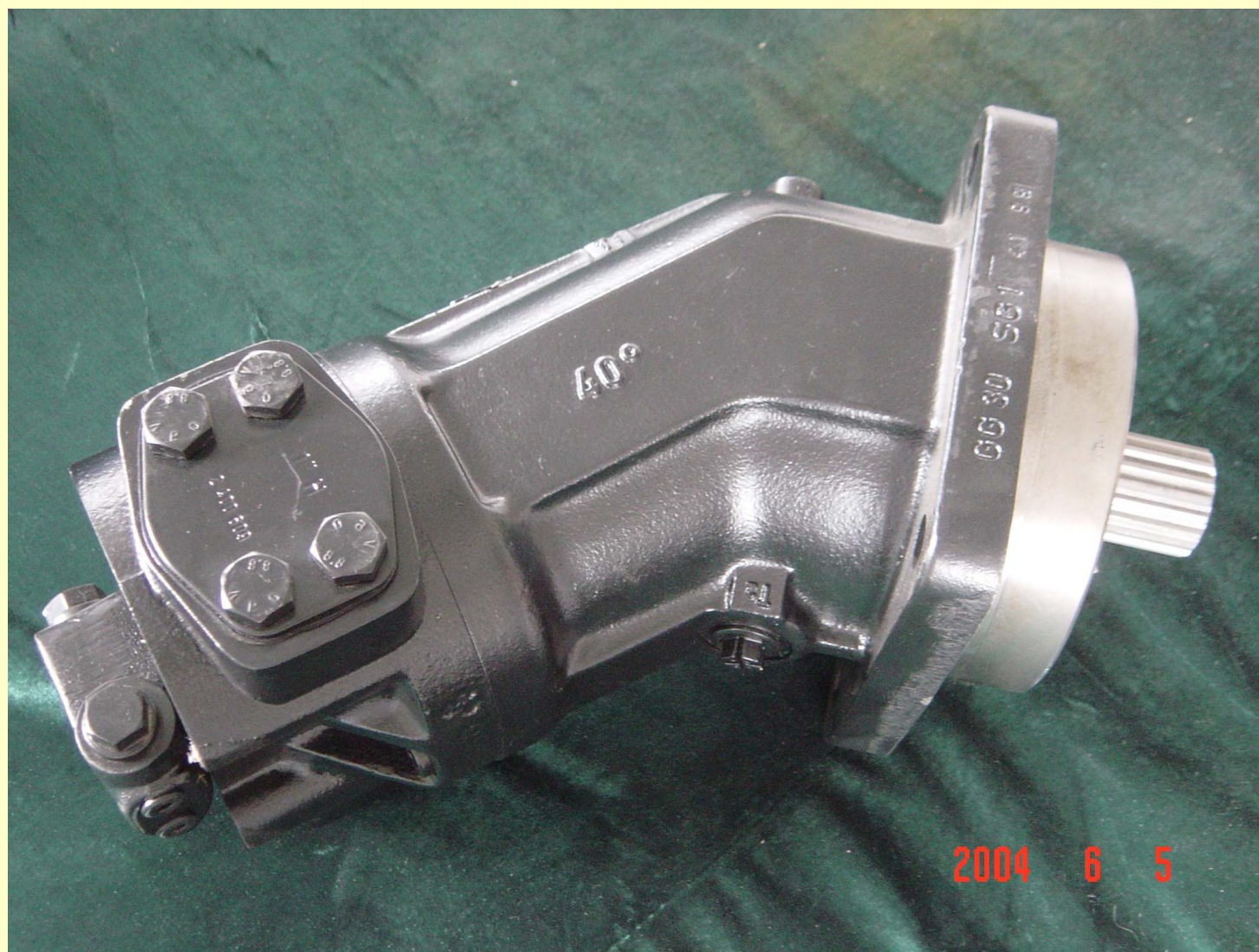
图中为斜轴式轴向柱塞泵外形
