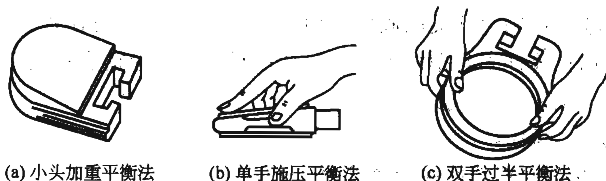
图 2-48 楔式闸板密封面的研磨方法
