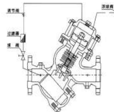
过滤活塞式遥控浮球阀原理图
