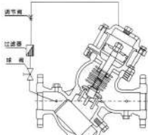
过滤式缓闭止回阀原理图
